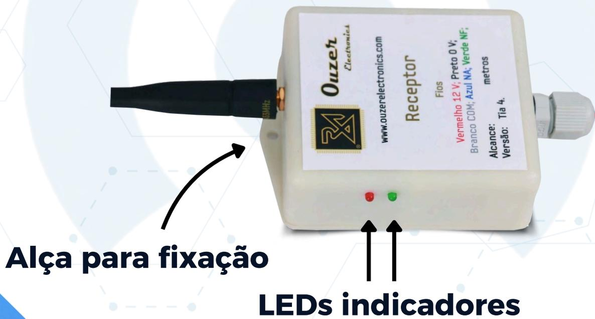
Figura 2. Alça para fixação e LEDs indicadores
